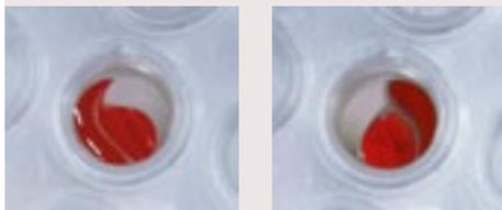
Фотография иллюстрирует процесс смешивания подкрашенной воды в планшете Eppendorf twin.tec® PCR Plate 96 в приборе MixMate® при частоте 1650 об./мин.
