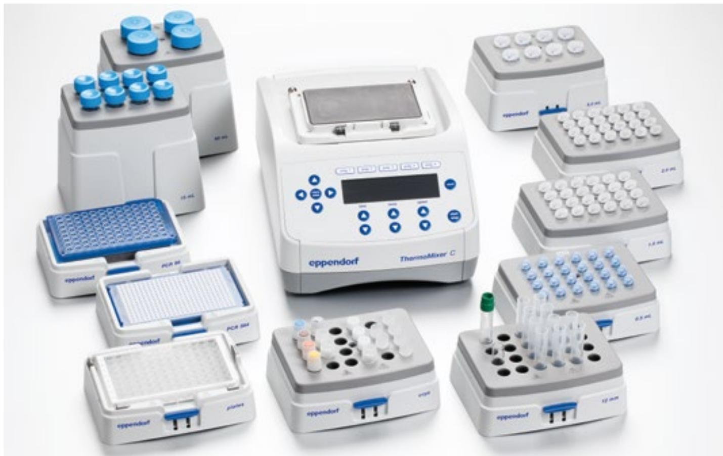
Для Eppendorf ThermoMixer C представлен широкий спектр термоблоков Eppendorf SmartBlocks. Это новое поколение сменных термоблоков обеспечивает максимальную гибкость в работе с различными типами пробирок и планшетов.
