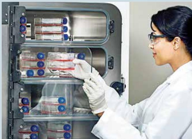
Дополнительное анти-микробное медное покрытие внутренней стороны камеры и соединительных элементов, включая поддон для создания влажности и полки, доступно для моделей Galaxy 170 R и 170 S. Устанавливаемые по желанию секционные двери улучшают однородность температуры и уменьшают потребление газов, в то же время обеспечивая простой доступ к образцам.
