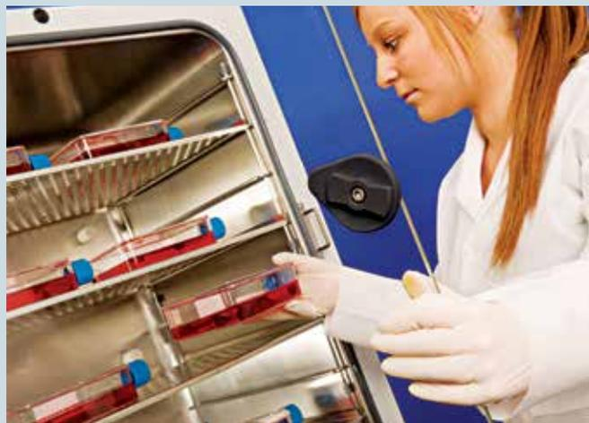
Быстрое установление одинаковой температуры, уровня CO<sub>2</sub> и влажности после открывания и закрывания двери обеспечивается использованием уникальных перфорированных полок.
