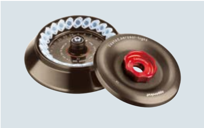
Аэрозоль-непроницаемый ротор на 24 пробирки объемом 1,5/2 мл с ПТФЭ покрытием для большей устойчивости к химическим веществам. Обеспечивает макс. ускорение (скорость вращения) до 21 130 x g/15 000 об/мин (FA-45-24-11-Special; № для заказа 5424 700.004)
