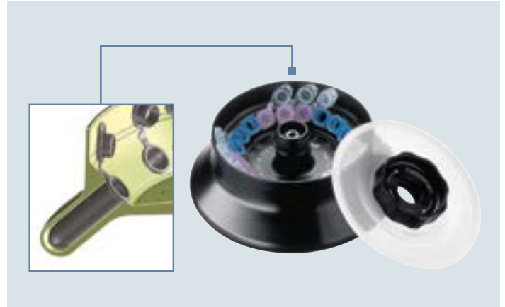
Eppendorf Kit rotor® на 18 спин-колонок или пробирок объемом 1,5/2 мл с макс. ускорением (скоростью вращения) до 18 111 x g/15 000 об/мин. Ротор изготовлен с увеличенным ободом для защиты крышек пробирок от срезания (FA-45-18-11-Kit; № для заказа 5424 706.002).
