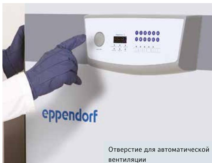
Отверстие для автоматической вентиляции
