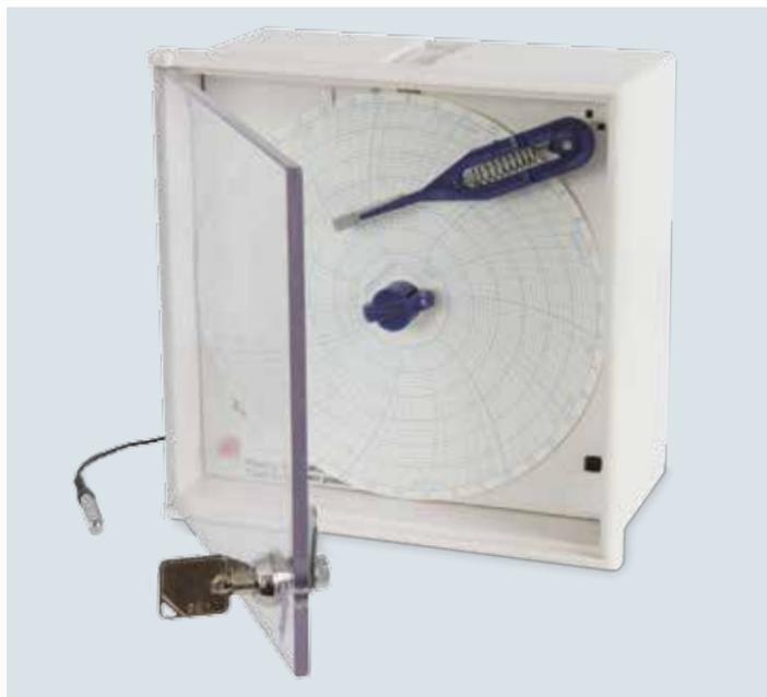
Системы резервного охлаждения жидкой углекислотой ( $\text{CO}_2$ ) или жидким азотом ( $\text{жN}_2$ ) (слева) и регистрирующий аналоговый самописец температуры (справа) могут быть установлены на заводе.
