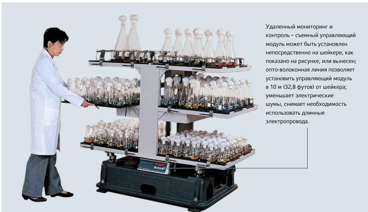
Удаленный мониторинг и контроль – съемный управляющий модуль может быть установлен непосредственно на шейкере, как показано на рисунке, или вынесен; опто-волоконная линия позволяет установить управляющий модуль в 10 м (32,8 футов) от шейкера; уменьшает электрические шумы, снимает необходимость использовать длинные электропровода.
