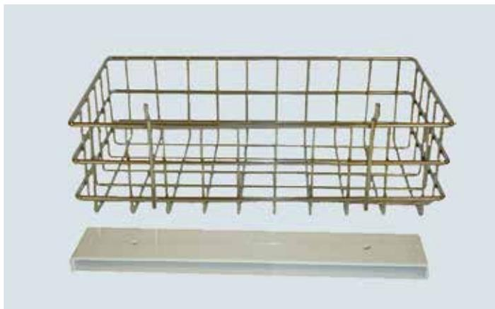
Корзина для принадлежностей для инкубации или охлаждения образцов в стационарных условиях; подставка (на переднем плане) крепится к боковой поверхности шейкера.
