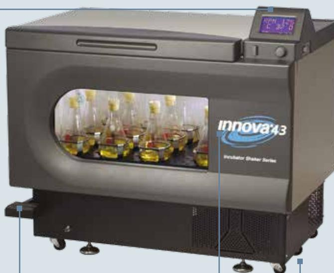
Большое изолированное смотровое окно с тройным стеклом и внутренней подсветкой сводят к минимуму необходимость открывать крышку; быстрая циркуляция воздуха обеспечивает быстрое установление нужной температуры.
