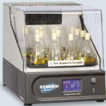
Прозрачная крышка обеспечивает хорошую видимость. Поднимается вверх, открывая доступ к образцам.
