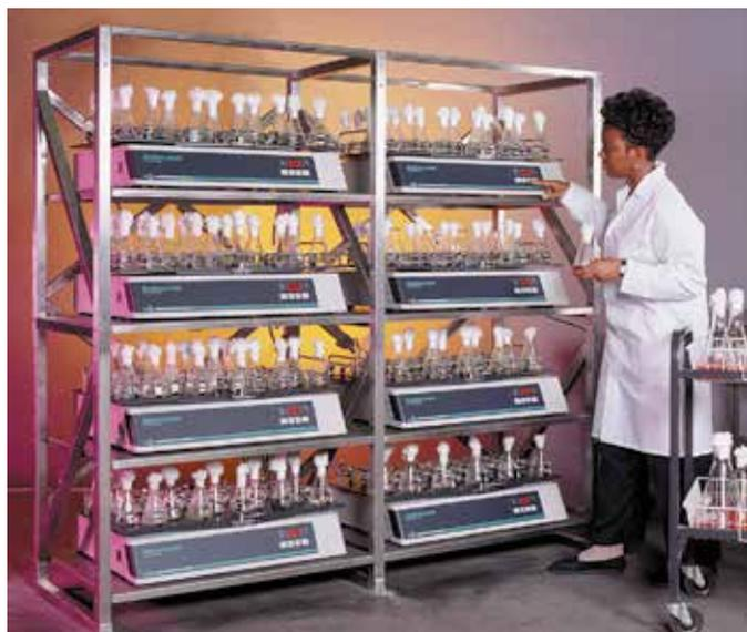
Стеллаж Innova 5050 (вмещает до 4 шейкеров Innova 2300) - на рисунке вместе со штативом для расширения, модель 5051, позволяющим дополнительно установить до 4 шейкеров. Блок электророзеток обеспечивает подключение к электросети<sup>2</sup>.
