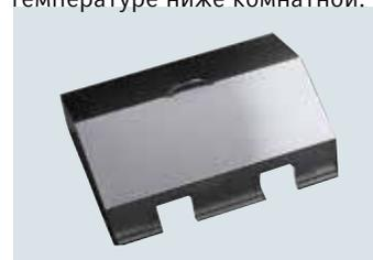
Остроконечная крышка для уменьшения охлаждения и испарения. Крышку из нержавеющей стали (на рисунке) рекомендуется использовать при температуре выше 80°С. Крышку Plexiglas® – при температуре выше 60°С.
